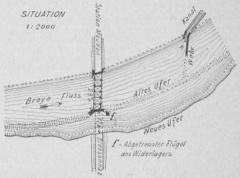
Die Eisenconstruction der Brücke als Fachwerk construirt mit Fahrbahn unten hat Trapezform mit einer Länge von 35,40 m, bei 33,10 m schiefer Oeffnung ( $\underline{1}$  Lichtweite 30 m) und bei einer Constructionshöhe von 5,70 m in der Mitte; sie wiegt ungefähr 50000 kg und kostete etwa 25000 Fr., während die Gesammtkosten des Objectes etwa 31000 Fr. betragen haben sollen.
