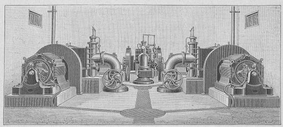
bronze. L'extrémité de l'arbre de chaque dynamo qui est en regard, porte une pièce semblable, et chaque axe du plateau de la turbine est relié à l'axe correspondant du plateau de la dynamo par une bague de caoutchouc.
