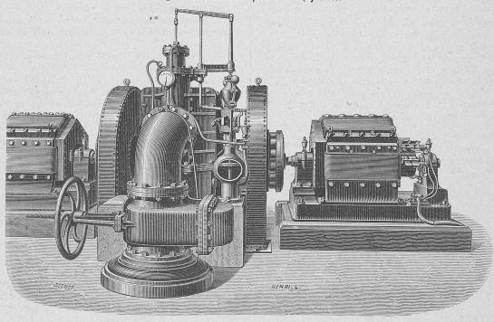
La commande directe de turbine à dynamo se faitpar l'intermédiaire de manchons élastiques connues sous le nom de manchons Raffard. Les turbines sont horizontales et à chaque extrémité de l'arbre qui sort de la bâche à droite et à gauche, on a claveté un plateau en fonte portant seize axes en fer, recouverts d'une douille mobile en donnant toujours quelques secousses au démarrage.
