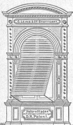
**Roll-Jalousien**, a) mit feststehenden Stahlbändern verbundenen Prismastäben m. schrägen Lichteinschnitten, b) verstellbar mittelst durchgesteckter Stahlplättchen (Profile unter Musterbeschreibung).
