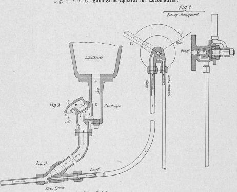
Fig. 1, 2 u. 3. Sand-Streu-Apparat für Locomotiven.
