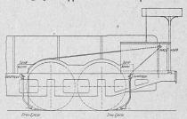
hin verlegt werden. Der Sand, welcher zur Verwendung kommt, soll fein, aber körnig, über dem Feuer (im Ofen) getrocknet sein, und keine fremden Körper, insbesondere keine Erdtheile enthalten. Die Oeffnung des Sandkastens, durch welche der Sand in die Sandtreppe fällt, soll durch ein Sieb von 3 mm Maschenweite geschützt werden.
