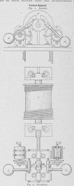
Schwimmer und rechts das Gegengewicht. Der Schwimmer, welcher in Zink oder Eisenblech ausgeführt ist, besteht aus einem ganz flach gehaltenen Hohlkörper von relativ grossem Volumen (65—75 cm Durchmesser und 15—20 cm Höhe).
