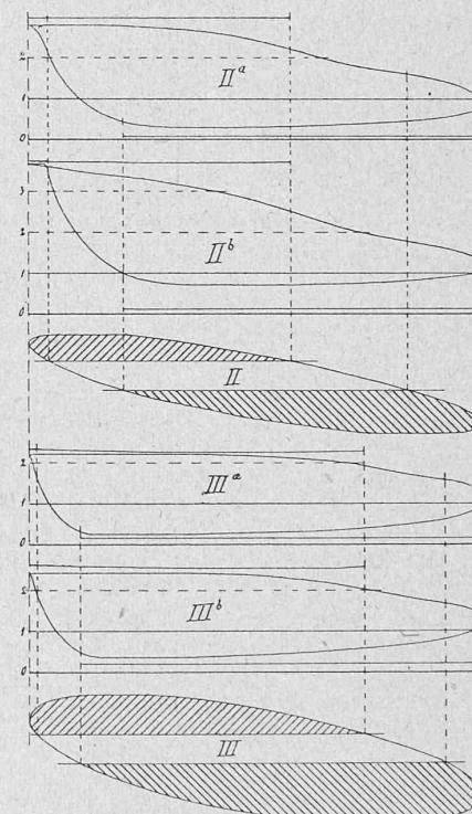
ganz geöffnet wird (max.  $e$  beträgt beim IV. Grade nur 13 mm) mit einer Mündung zu thun, die man als eine „theilweise besetzte Mündung in dünner Wand“ wird ansehen dürfen. Der „Besatz“ wird gebildet durch die äussere Begrenzungsfäche des Schieberlappens. Für eine solche Mündung ist  $\mu$  grösser, als für eine Mündung in dünner Wand ohne Besatz, dagegen ist es kleiner, wie bei einer gut abgerundeten Mündung. Man wird also jedenfalls nicht stark fehl greifen, wenn man für das Einströmen rund
