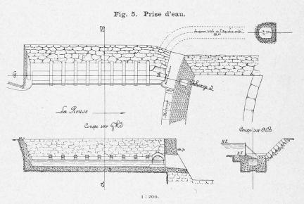
Le déversoir est protégé contre la poussée du talus du chemin de fer par un fort mur de revêtement. Pour empêcher les eaux qui retombent dans la rivière à cet endroitlà de produire des dégradations il a été fait un enrochement solide, couvert d'un bétonnage. A l'extrémité d'aval du déversoir le passage de l'eau, qui doit entrer dans le canal de dérivation proprement dit, se règle au moyen d'une vanne; le trop-plein retourne à la rivière.
