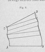
lung AB nach CD, so dass die Endpunkte die Curven AC und BD beschreiben, so setzt sich die Fläche AB CD aus den eben betrachteten Elementarflächen, aus lauter unendlich kleinen Parallelogrammen und Sectoren zusammen, wobei ein Schneiden der Stablagen nach § 7 nicht ausgeschlossen ist. Werden die unendlich kleinen Höhen der Parallelogramme mit  $b_1$   $b_2$   $b_3$ ... ihre Summe mit  $\Sigma$  (b),
