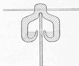
Regentropfen völlig zu verhindern und die Ablagerung von Nebeltröpfchen bei Nebelwetter möglichst zu erschweren, sind die Querschnittsdimensionen von Isolator und Tragstange so bemessen, dass zwischen der Stangenoberfläche und der innersten Fläche des Isolators nur ein sehr schmaler Luftzwischenraum bleibt.
