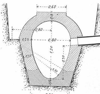
Das Engschräffte bedeutet Portland-Cement; das Weitschräffte Roman-Cement-Beton.
