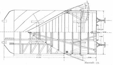
Fig. 6. Hintere Ansicht bei geöffnetem und eingezogenem Flügel.
