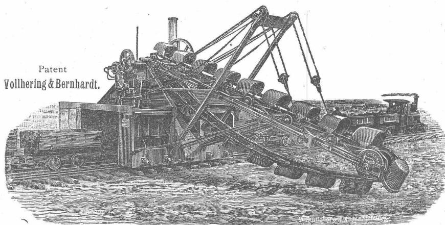
Für Abträge erhält der Apparat eine umgekehrte aufgelegte Eimerkette.
