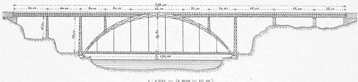
La distance entre les arcs est de 6,50 m à la clef, et de 18 m aux retombées. La voie supérieure passe entre les membrures, sur les 107 m de la partie horizontale de l'extrados; au delà, à droite et à gauche, des tabliers spéciaux les raccordent avec les culées.
