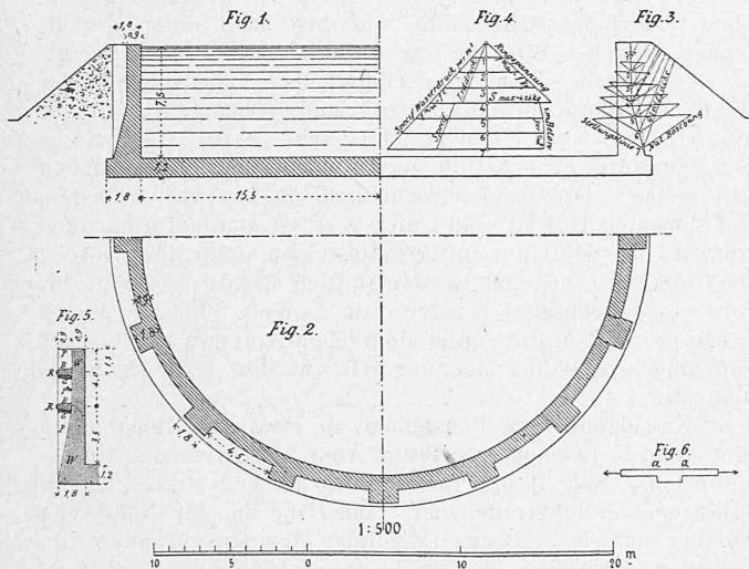
Die vorstehende Zeichnung stellt das Bassin in Grundriss und Querschnitt dar, so wie es vom Unternehmer projectirt und ausgeführt wurde. Die Wandstärke beträgt an der Krone  $90\text{ cm}$  und an der Basis  $1,80$ . Auf den 14 Verstärkungspfeilern steht je eine  $54\text{ q}$  schwere Leitwerksäule, die den Gasbehälter von  $5000\text{ m}^3$  im Gleichgewicht hält. Diese Säulen sind, wie üblich, auf den Pfeilern stark verankert und oben durch Fachwerke im Kreise mit einander verbunden.
