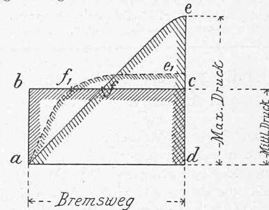
Bremsarbeit =  $a b c d = a d e f$ , oder auch für langsame Wirkung =  $a d e_1 f_1$ .
