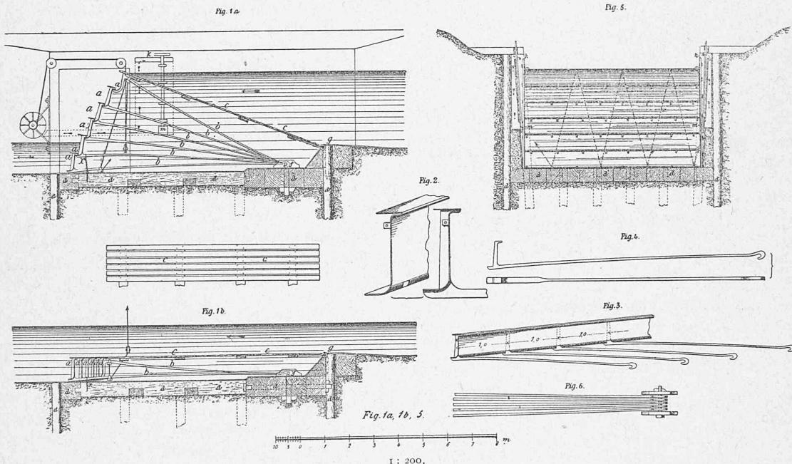
nicht allein von dem absoluten Gewichte der einzelnen Schütz-Constructions-Theile, sondern auch hievon abhängig ist, dass der Anschluss der Schütze durch das Ineinander greifen ihrer Abkröpfungen (Fig. 1a) ein genügender und möglichst dichter sei, so ist es in den meisten Fällen nothwendig, die unteren Abkröpfungen breiter zu halten, als es nach dem zuvor angeführten Prinzip nothwendig wäre.
