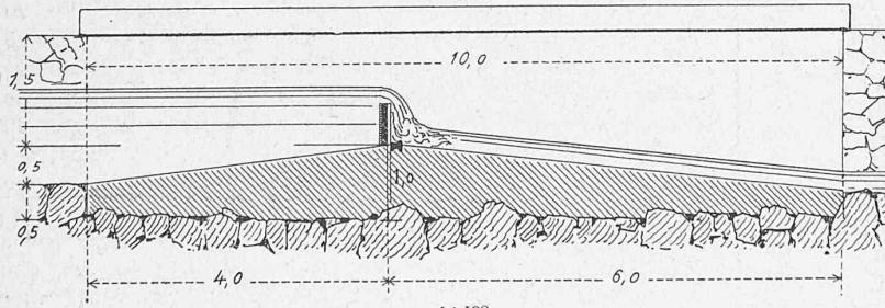
**Material:** comprimirter Schlackensandbéton; **Mischungsverhältniss:** 1 Vol. Mörtel : 3,0 Vol. Kies. Die Mörtel- und Bétonbereitung geschah in der „Brückenmanier“. Es beträgt: die Sohlenbreite des Wehres . . . . . 10 m die Kronenhöhe über Fundament . . . . . 1,5 m die Länge des Wehres zwischen den Flügelmauern 22,0 m die verwendete Bétonmenge . . . . . ca. 310,0 m<sup>3</sup>
