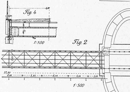
Die bleibenden Einsenkungen sind durch tiefere Einpressionsen und kleine Verschiebungen der Bogen in den Nischen der Auflagerplatten zu erklären, so dass eigentlich erst durch die Probebelastung die Construction ihre definitive Lage innert der Widerlager erhalten hat.
