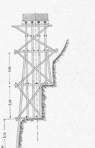
Fig. 2. Lehrgerüst, Schnitt AB. Fig. 3. Lehrgerüst, Schnitt CD.
