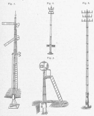
Die oben erwähnten Signalmaste werden in ähnlicher Construction auch für Telephondienst verwendet (siehe Figur 6 und 8). Sie sind ganz aus gezogenen Röhren construirt, welche mit einer genügenden Zahl schmiedeiserner Querverbindungen solide verbunden werden.
