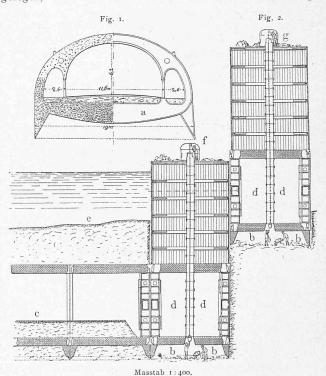
Legende: a. Schmiedeiserne Tragconstruction, je 6,1 m von einander abstehend. b. Arbeitsraum, mit comprimirter Luft gefüllt. c. Fahrstrasse. d. Provisorischer Schutz gegen das Eindringen von Wasser, e. Flussbett. f und g. Luftabschluss.
