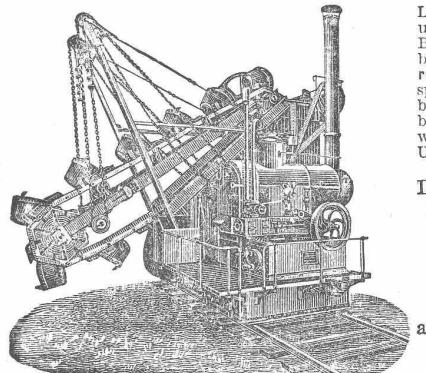
Leistung: 2000 cbm in leichtem, und 1500 cbm in sehr schwerem Boden. Der Apparat schüttet baggernd und langsam fahrend den ruhenden normal oder schmal spurigen Arbeitszug voll. Apparatsbedienung 3 Mann, Kohlenverbrauch 15 bis 20 Ctr., zum Schienenwerfen 10 Mann. Diese sämtlichen Unkosten betragen pro Tag incl. Amortisation 60—70 Mark.
