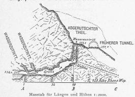
war, dieselbe in regelmässiger Weise auszuführen und zu bekleiden, so beschränkte man sich darauf, die schlechtesten und steilsten Mergelpartien mittelst Ziegelsteinmauerwerk trocken (0,30–0,40 m dick) zu verblenden und so dem Einflusse von Frost und Regen zu entziehen. Der gesammte übrige Theil dieser durch die Abrutschung gebildeten Böschung wurde mit einer wenige mm dicken Theerschichte überzogen, ebenso die vorerwähnten Ziegelmauerverkleidungen.
