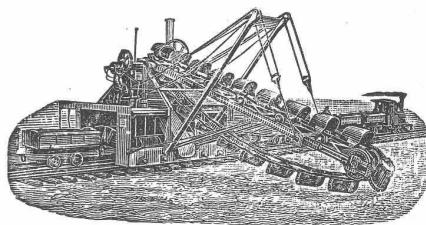
Leistung: 2000 cbm in leichtem, und 1500 cbm in sehr schwerem Boden. Der Apparat schüttet baggernd und langsam fahrend durch normal oder schnellspurigen Arbeitszug voll. Apparatsbedienung 3 Mann, Kohlenverbrauch 15 bis 20 Ctr. zum Schienenwerken 10 Mann. Diese sämmtlichen Unkosten betragen pro Tag inkl. Amortisation 60—70 Mark.
