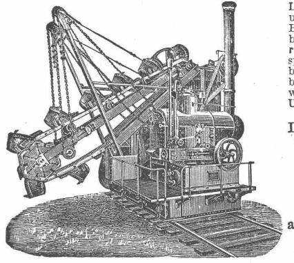
Leistung: 2000 ehm in leichtem, und 1500 ehm in sehr schwerem Boden. Der Apparat schüttet baggernd und langsam fahrend durch normal oder schnellspurigen Arbeitszug voll. Apparatsbedienung 3 Mann, Kohlenverbrauch 15 bis 20 Ctr. zum Schienenwerken 10 Mann. Diese sämmtlichen Unkosten betragen pro Tag inkl. Amortisation 60—70 Mark.
