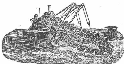
Leistung: 2000 cbm in leichtem, und 1500 cbm in sehr schwerem Boden. Der Apparat schüttet baggernd und langsam fahrend durch normal oder schnellspurigen Arbeitszug voll. Apparatsbedienung 3 Mann, Kohlenverbrauch 15 bis 20 Ctr. zum Schienenwerfen 10 Mann. Diese sämmtlichen Unkosten betragen pro Tag inkl. Amortisation 60—70 Mark.
