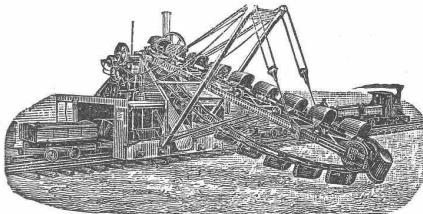
Leistung: 2000 cbm in leichtem, und 1500 cbm in sehr schwerem Boden. Der Apparat schüttet baggernd und langsam fahrend den ruhenden normal oder schmal-spurigen Arbeitszug voll. Apparatbedienung 3 Mann, Kohlenverbrauch 15 bis 20 Ctr., zum Schienenwerken 10 Mann. Diese sämtlichen Unkosten betragen pro Tag incl. Amortisation 60—70 Mark.
