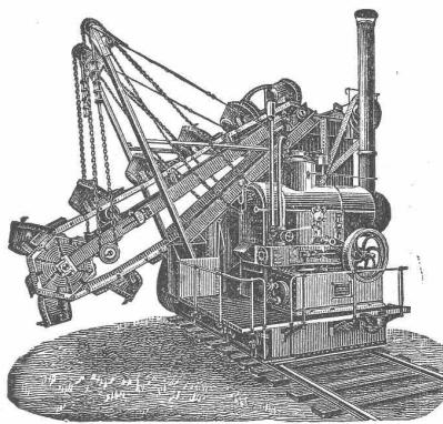
Leistung: 2000 cbm in leichtem, und 1500 cbm in sehr schwerem Boden. Der Apparat schüttet baggernd und langsam fahrend den ruhenden normal oder schmal-spurigen Arbeitszug voll. Apparatbedienung 3 Mann, Kohlenverbrauch 15 bis 20 Ctr., zum Schienenwerfen 10 Mann. Diese sämtlichen Unkosten betragen pro Tag incl. Amortisation 60—70 Mark.
