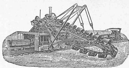
Leistung: 2000 cbm in leichtem, und 1500 cbm in sehr schwerem Boden. Der Apparat schüttet baggernd und langsam fahrend den ruhenden normal oder schnellspurigen Arbeitszug voll. Apparatbedienung 3 Mann. Kohlenverbrauch 15 bis 20 Ctr., zum Schienenwerfen 10 Mann. Diese sämtlichen Unkosten betragen pro Tag incl. Amortisation 60—70 Mark.
