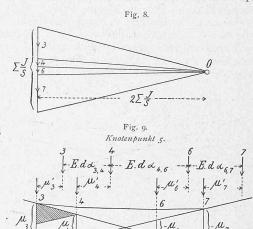
$\mu'$  nach links, lässt in den verschobenen Verticalen Kräfte von der Intensität J wirken und setzt sie durch ein Seilpolygon zusammen. Als Poldistanz für das Kräftepolygon (Figur 8) nimmt man die doppelte Summe der vier  $\frac{J}{c}$ . Dann schneiden die erste und letzte Seilpolygonseite auf den verschobenen Verticalen die Werthe  $\mu$  ab.
