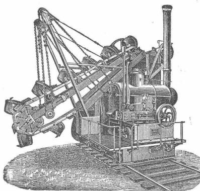
Leistung: 2000 cbm in leichtem, und 1500 cbm in sehr schwarem Boden. Der Apparat schüttet baggern und langsam fahrend den ruhenden normal oder schnellspanigen Arbeitszug voll. Apparaturbedienung 3 Mann, Kohlenverbrauch 15 bis 20 Ctr., zum Schienenwerfen 10 Mann. Diese sämtlichen Unkosten betragen pro Tag incl. Amortisation 60—70 Mark.
