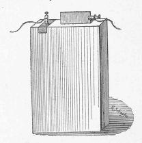
L'Accumulateur de poche (fig. 5) est un appareil d'amateur qui peut illuminer un très petit foyer électrique pendant une heure. Il se compose d'une lame de zinc amalgamé suspendue dans une boîte en plomb, peroxydée intérieurement et remplie d'eau acidulée sulfurique. Un couvercle en bois, scellé avec un mastic bitumeux et muni d'un bouchon de sûreté, ferme l'accumulateur. Le tout est placé dans un étui léger, de la grosseur d'un portefeuille.
