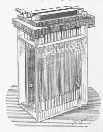
Ces plaques fonctionnent comme électrodes positives ou négatives. On les monte dans des récipients étanches garnis d'eau acidulée sulfurique, en reliant d'une part les plaques paires (positives), d'autre part les plaques impaires (négatives). Leur formation est faite par le procédé Planté; elle dure en moyenne 600 heures.
