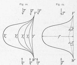
Die Grenze der Ausbiegung wird erreicht, wenn der Ausbiegungswinkel  $\mathcal{L}_g \tau$  an den Befestigungsstellen V und W gegen den Biegungspfeil F verschwindet, mit anderen Worten, wenn der Stab unter der Einwirkung der Last in denjenigen schwankenden Zustand geräth, für welchen, die Fläche des Stabquerschnitts  $=\omega$  und deren Trägheitsmoment =J gesetzt, die bekannte Beziehung gilt:
