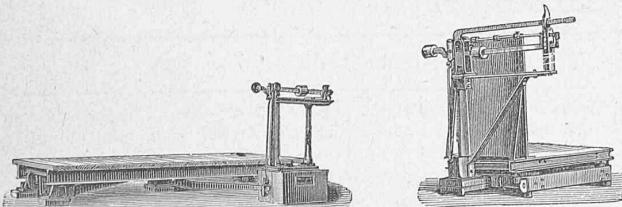
Waggonwaagen ohne Geleisunterbrechung.
