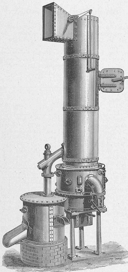
Jedes Gebläserohr hat ein Ventil, das mit den Ventilen der gleichen Zone verbunden ist, um mit denselben gleichzeitig geöffnet oder geschlossen zu werden. Der Gesammt-Querschnitt der Röhren jeder Zone ist so berechnet, dass die Luft am vortheilhaftesten vertheilt, und der Brennstoffverbrauch auf ein Minimum reducirt wird.
