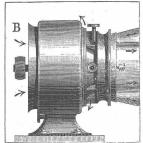
entweder direct von einer Druckwasserleitung aus durch **Turbine** (A) oder, wo Druckwasser nicht vorhanden, durch **Riemen** von einer Transmission aus betrieben (B), zur **rationellen** und **wirksamen** Ventilation von **Spinnereien**, **Webereien** und anderen **Fabrikräumen**, **Wirthschaftslocalen**, **Concertsäälen**, **Restaurants** etc., gleichzeitig frische Luft eintreibend und die verdorbene absaugend, mit oder ohne **Luftbefeuchtung**. Kostenanschläge gratis.
