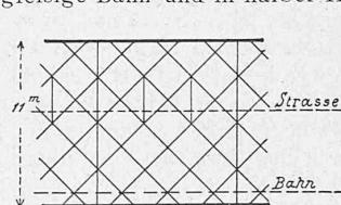
Die Streben laufen sämmtlich geneigt in siebenfachem System und besitzen ohne Ausnahme steifen Querschnitt; merkwürdigerweise sind sie an den Gurtungen stark exzentrisch befestigt. Die Strassenfahrbahn findet ihren Halt in verticalen Pfosten; von diesen läuft indessen nur je der dritte von der oberen bis zur unteren Gurtung durch; die übrigen sind blos ca. 3 m lang und kurzweg an den Kreuzungspunkten der Streben aufgehängt.
