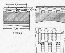
eingeschränkt und tragen auf Langschwellen den Querschwellenoberbau (Fig. 22). Diese schmalen Mauerwerks-Constructionen sind bekanntlich schon in den vierziger Jahren in Nordamerika und in ähnlicher Weise u. A. 1872 auch in Frankreich zur Ausführung gelangt.
