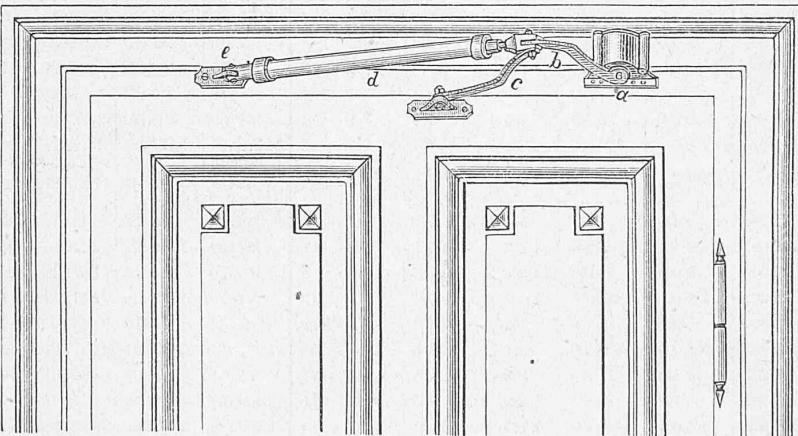
1. aus einer solid gearbeiteten Feder im Gehäuse  $\alpha$ , welche durch das daran befestigte Stellrad je nach Bedürfniss mehr oder weniger angespannt werden kann;
