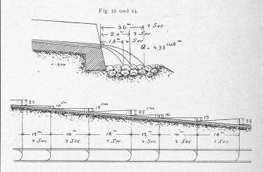
kopfes (im Grundriss) lässt sich erklären, sie bildet beim Uebergang des Wassers auf die flache Sohle eine Geschwindigkeitscurve für das Wasser des oberen Querschnitts, die schneller fliessenden Wasserfäden der Mitte werden den andern voraneilen; über die Bildung der Wellen aber ist man noch im Unklaren.
