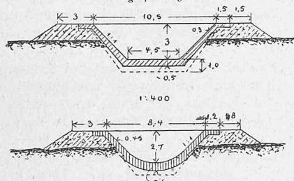
gefasst; unterhalb der Schlucht wurde gleichfalls eine Schale von 547 m Länge angelegt, aber mit abgerundeter Sohle (Fig. 5) und 10—13 % Gefäll. Beide Schalen sind durch 1,8 m breite Rippen in 30—60 m Entfernung verstärkt.
