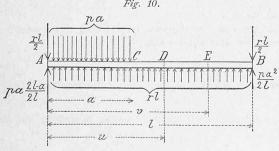
Das Moment in einem um u vom linken Auflager entfernten Punkte bei einer über a sich erstreckenden Belastung wird nun (siehe Figur 10)
