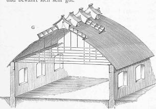
Fig. G ist ein tropfsicheres Färberei-Dach mit isolirten Firstblechen, Dunstaufsätzen und Reiterlaternen;
