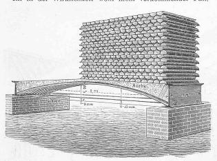
— Die Einsenkung, welche von angebrachten Scalen genau abzulesen war, betrug im Scheitel 9 mm, bei ½ der Spannweite also unterm Mittel der belasteten Seite 15 mm, während der Bogen auf der unbelasteten Seite sich um 7 mm gehoben hatte.
