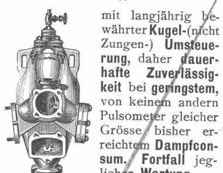
mit langjährig bewährter Kugel-(nicht Zungen-) Umsteuerung, daher dauerhafte Zuverlässigkeit bei geringstem, von keinem andern Pulsometer gleicher Grösse bisher erreichtem Dampfconsum. Fortfall jeglicher Wartung.
