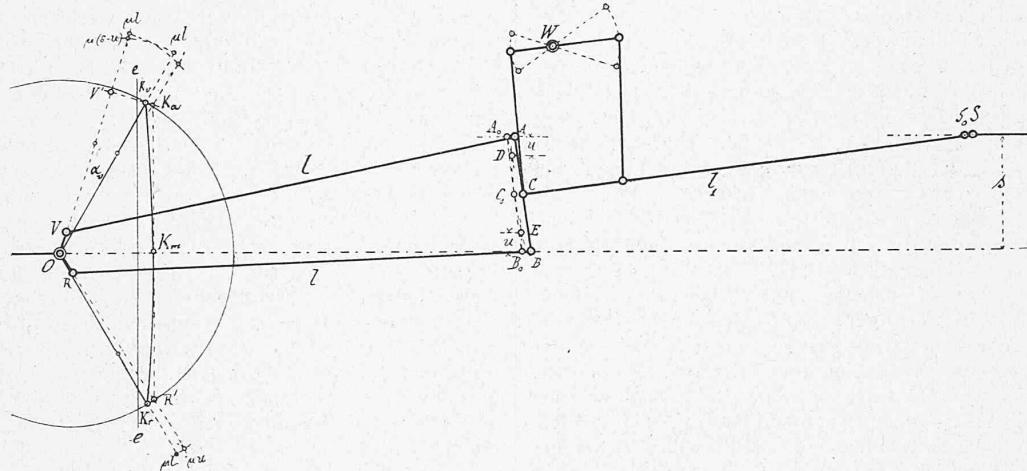
Bei ganz vorgelegter Steuerung kommen nun  $A$  und  $C$  in die Horizontale durch  $D$ , und die Schubrichtung des Endpunktes der Excenterstange liegt um  $s - u$  über  $O$ . Trägt man daher einen Winkel  $\alpha_v$ , so gross, dass
