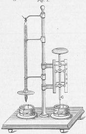
lung. Ueber dem abwärts konisch gestalteten Quecksilbergefäss wurde an den gläsernen Thermometer-Mantel ein Bügel befestigt, der beim Eintauchen des Quecksilbergefässes in den unter das Thermometer geschobenen Cementkuchen von constanten Abmessungen, das Quecksilbergefäss stets in die Kuchenmitte zu versenken gestattet. Mittelst dieses kleinen Apparates konnten nun einerseits die Temperaturänderungen, andererseits der Verlauf des Erhärtungsprocesses eines Cementes beobachtet werden.
