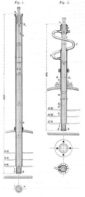
dem obern Theil a durch ein Schlangenrohr c verbunden. Mittelst eines mit Gewinde versehenen Flantsches wird der Apparat so auf den Kessel befestigt, dass das Innenrohr bis in die Nähe der höchsten vom Feuer berührten Theile, das äussere unten offene Rohr bis zur Höhe des vorher zu bestimmenden niedrigsten Wasserstandes reicht. In dieser Stellung wird der Apparat mit einer Gegenmutter fixirt.
