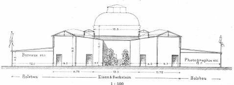
Die schraffirte Linie ist der Querschnitt durch den Mittelsaal.
