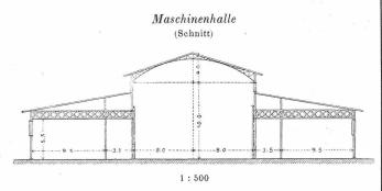
Die mit dem Hauptgebäude durch die Wagenhalle in directer Verbindung stehende 95,2 m lange und 41,6 m breite Maschinenhalle ist ein dreischiffiger Raum, dessen Seitenschiffe mit Howe'schen Trägern überdeckt sind, welch' letztere zum Montiren leichterer Maschinenstücke wohl angehen. Das Mittelschiff ist ziemlich bedeutend überhöht. Diese Halle ist von der Düsseldorfer Ausstellung erworben
