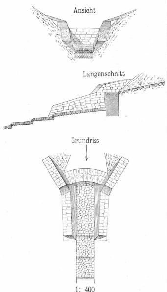
Die Construction dieser Sohlenversicherung ist eine sehr einfache: In Abständen von  $6-10\,m$  werden Querhölzer aus guten Lärchen oder auch zwei übereinander in die seitlichen Hänge gut eingegraben und die Sohle zwischen diesen mit eirea  $50\,cm$  hohen festen Steinen so ausgepflastert, dass je die untenliegende Fläche bei dem Querholz einen kleinen Absatz bildet und dadurch eine Gefällsverminderung erzeugt wird.
