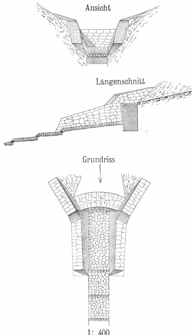
Die Construction dieser Sohlenversicherung ist eine sehr einfache: In Abständen von 6–10 m werden Querhölzer aus guten Lärchen oder auch zwei übereinander in die seitlichen Hänge gut eingegraben und die Sohle zwischen diesen mit circa 50 cm hohen festen Steinen so ausgepflastert, dass je die untenliegende Fläche bei dem Querholz einen kleinen Absatz bildet und dadurch eine Gefällsverminderung erzeugt wird.
