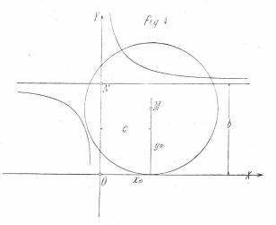
Schneidet man diesen Kreis durch eine gleichseitige Hyperbel. deren Parameter a ist und deren Mittelpunkt N (siehe Fig. 4) auf der y Achse im Abstande b von der x Achse sich befindet, deren Gleichung also:
