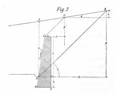
et si on le construit, le déblai que l'on sera encore obligé de faire se réduit au cube de la maçonnerie plus celui qui a pour section ACDI, c'est à dire à
