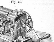
weder durch eine Kurbel oder durch eine um die Axe der inducirten Walze aufgewickelte Schnur in Bewegung gesetzt werden. 1. Im Feld wird derselbe durch eine Kiste von Hartholz gegen die Einflüsse der Witterung geschützt. Die Function der Stromerzeugung ist analog derjenigen bei der dynamo-electrischen Maschine.
